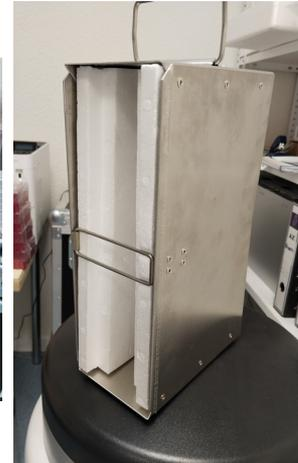
Contenedor seco de LN2 con sistema de transporte
